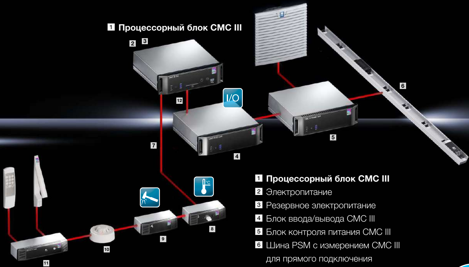
7 Возможно подключение до 16 систем CAN-Bus
